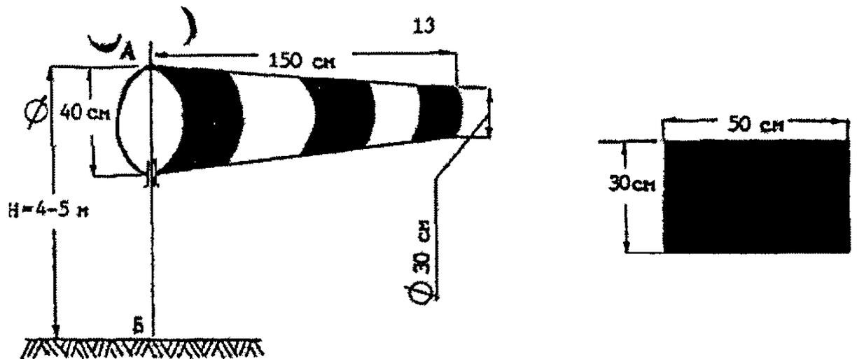
Рис. 2. Размеры, конфигурация конуса (а) и флага (б).
